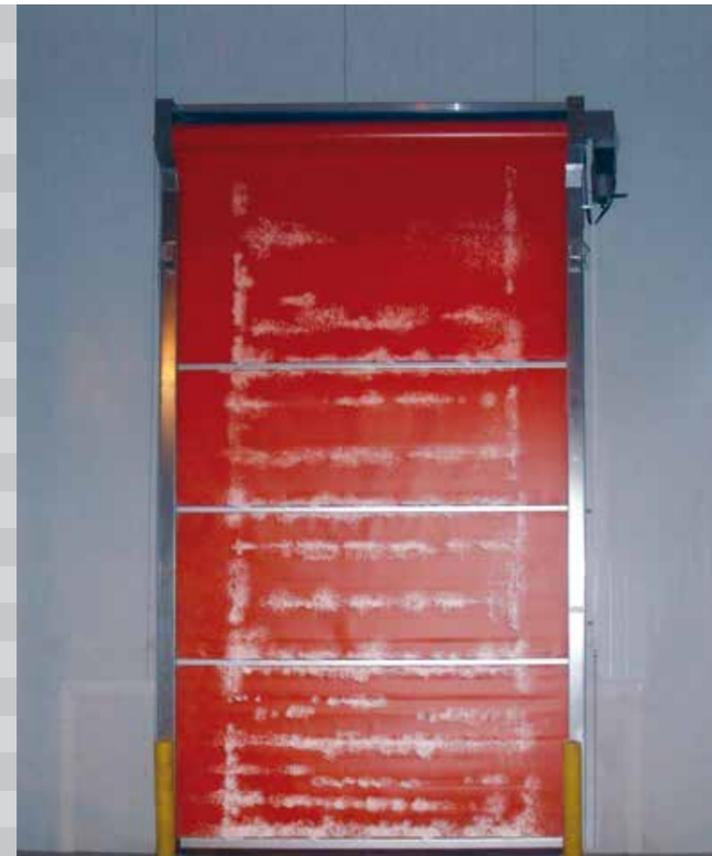
Das Polara bietet eine wirksame Abdichtung in Kühlhäusern und Tiefkühlhäusern. Die Führungsschienen, der Schaltschrank und die Sicherheitslichtschranke werden erwärmt. Das Tor öffnet sich automatisch alle 15 Minuten, um Vereisungen zu vermeiden.
